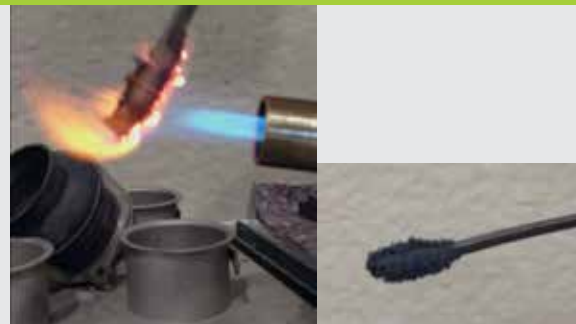
Kunststoffprüfkörper mit Blähgraphit während und nach dem Brandtest
