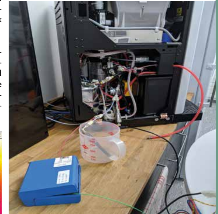
Versuchsaufbau zur höchstauflösenden Druckmessung am Kaffeetränkeautomaten
