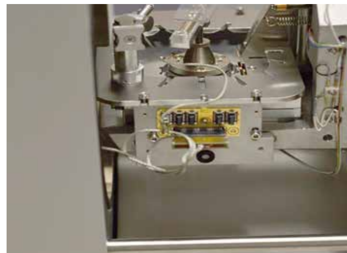
Blick auf den Proben Tisch des geöffneten REM mit installiertem Kleinstroboter zur Manipulation der Proben.
